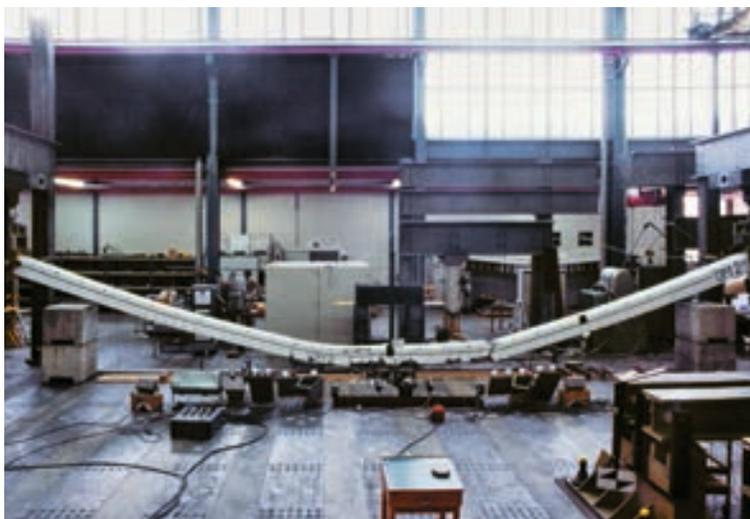
Bild 1-6: Ein Stahlbetonbalken nach mehreren Fallversuchen.
